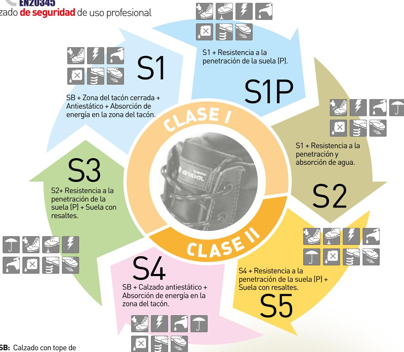
**SB:** Calzado con tope de seguridad (interior puntera) resistente a 200 J.
